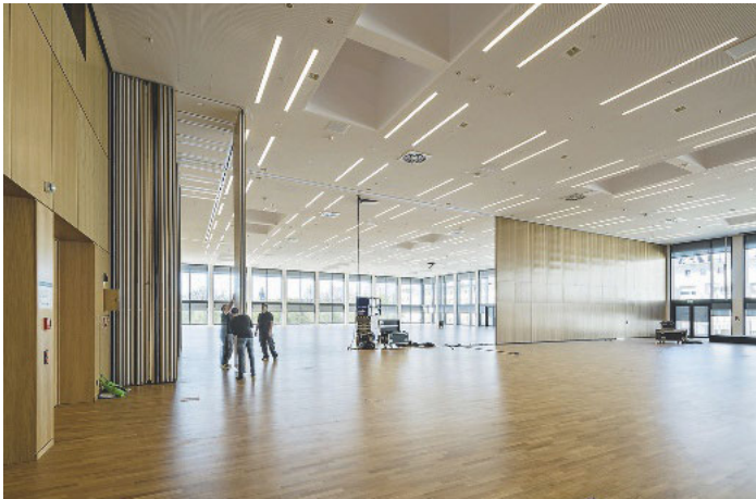
/ Flexible Raumentrennung: Der gut 2500 m 2 große Terrassensaal im zweiten Obergeschoss der Südhalle lässt sich durch flexible Wände (Abopart Mobilwand) aufteilen.
